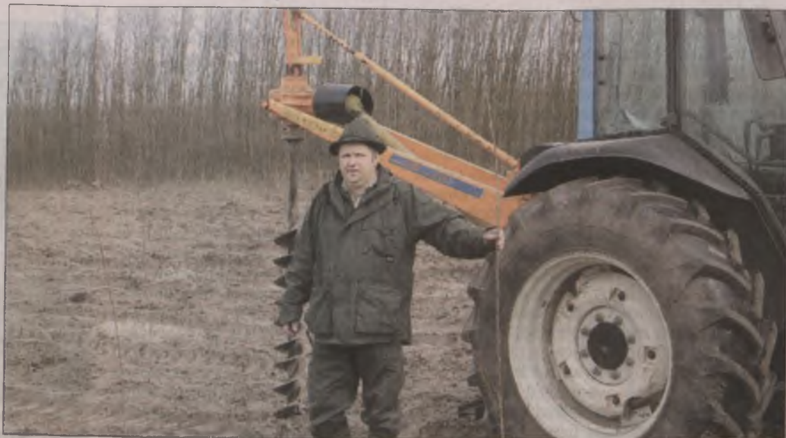
A gödörfúróval akár két méter mélyre is kerülhet a csemete gyökere
